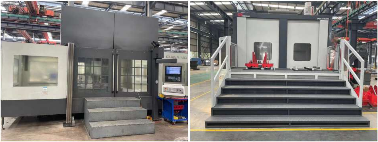
西班牙尼古拉斯DIANA MG20加工中心 意大利特雷维桑DS600200C加工中心
